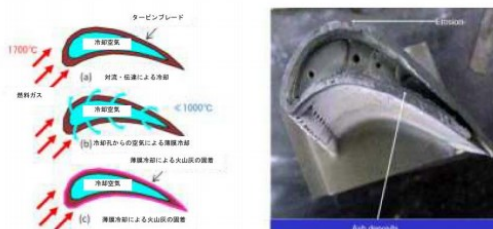
タービンブレードの冷却による火山灰の影響 (左) 模式図、(右) 付着事例 (安田・他, 2011)
