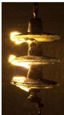
火山灰を用いた碍子の閃絡実験 (Wilson et al, 2011)
